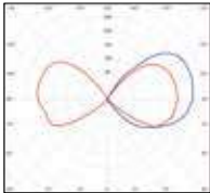
Modèle 2 E27 (2450 lm) Flux sortant - 1304 lm
